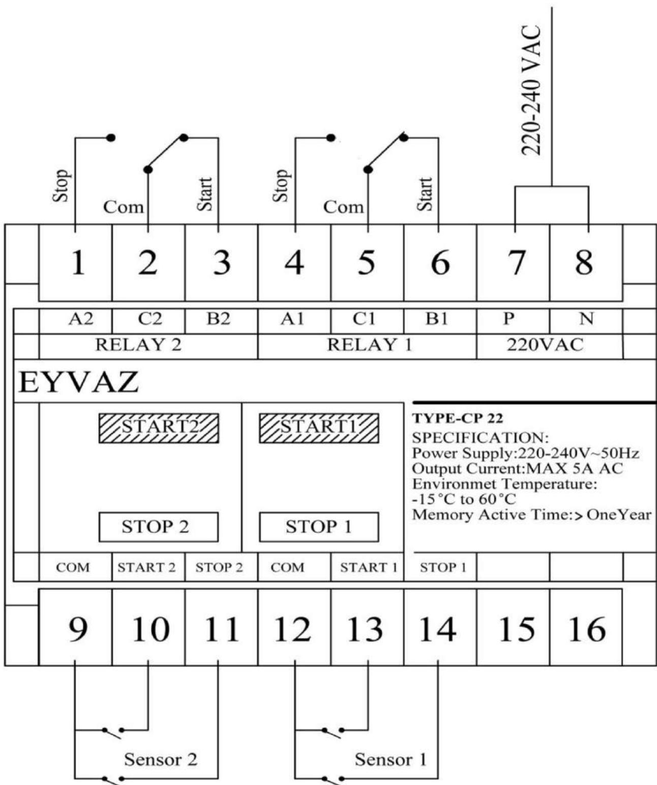
Terminals 2, 5 (C1, C2) are entrance of 5 ورودی رله داخل پنل می باشد
