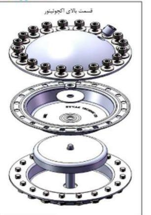
باید به این نکته توجه شود که دیافراگم را حتماً مطابق شکل مونتاژ نمائید به گونه ای داخل دیافراگم به سمت قسمت بالای اکچوئیتور قرار گیرد ، در غیر اینصورت امکان آن وجود دارد که دیافراگم جدید دچار مشکل گردد.
